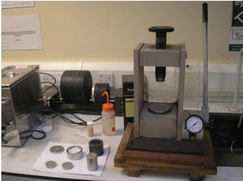
Figura 28 – Prensa hidráulica utilizada. Foto: Bezerra, 2009.
