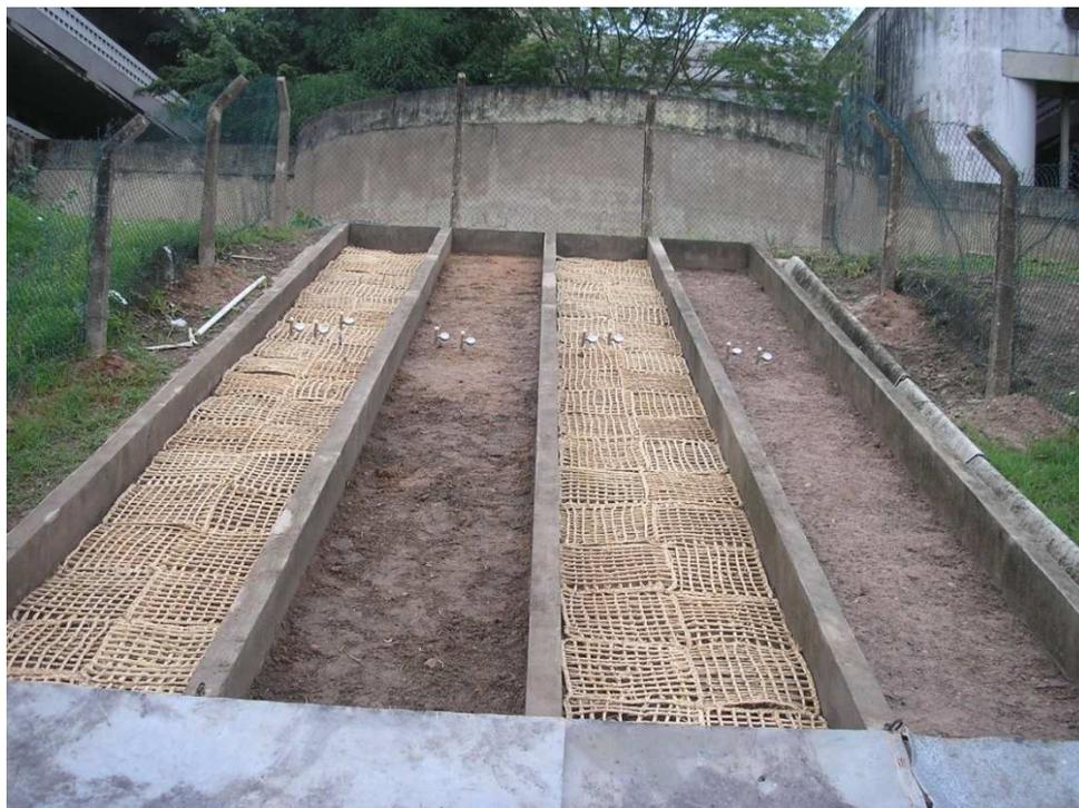
Figura 74 – Estação experimental sem a presença de cobertura de gramíneas.
