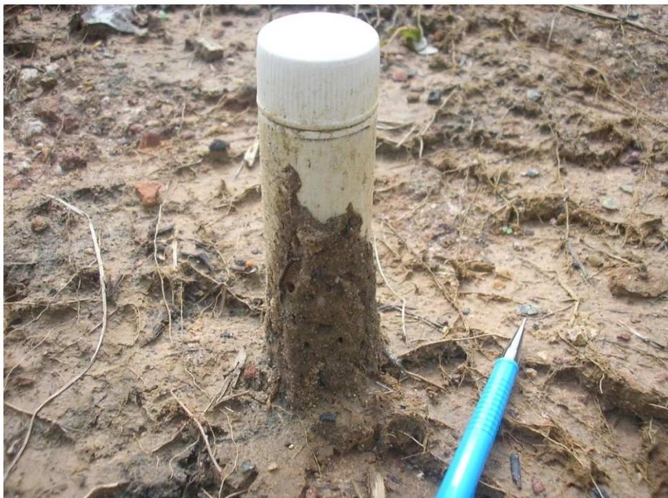
Figura 78 – Erosão por salpicamento na parcela com solo exposto a.
