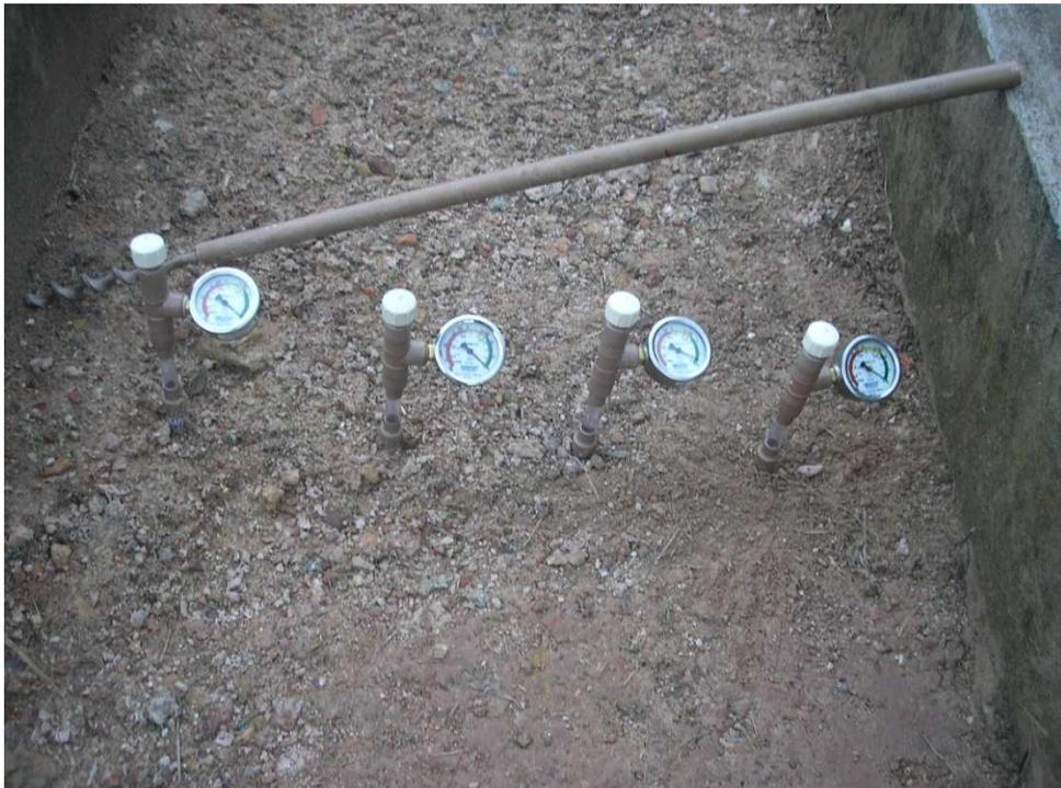
Figura 17 - Trado adaptado para instalação dos tensiômetros.
