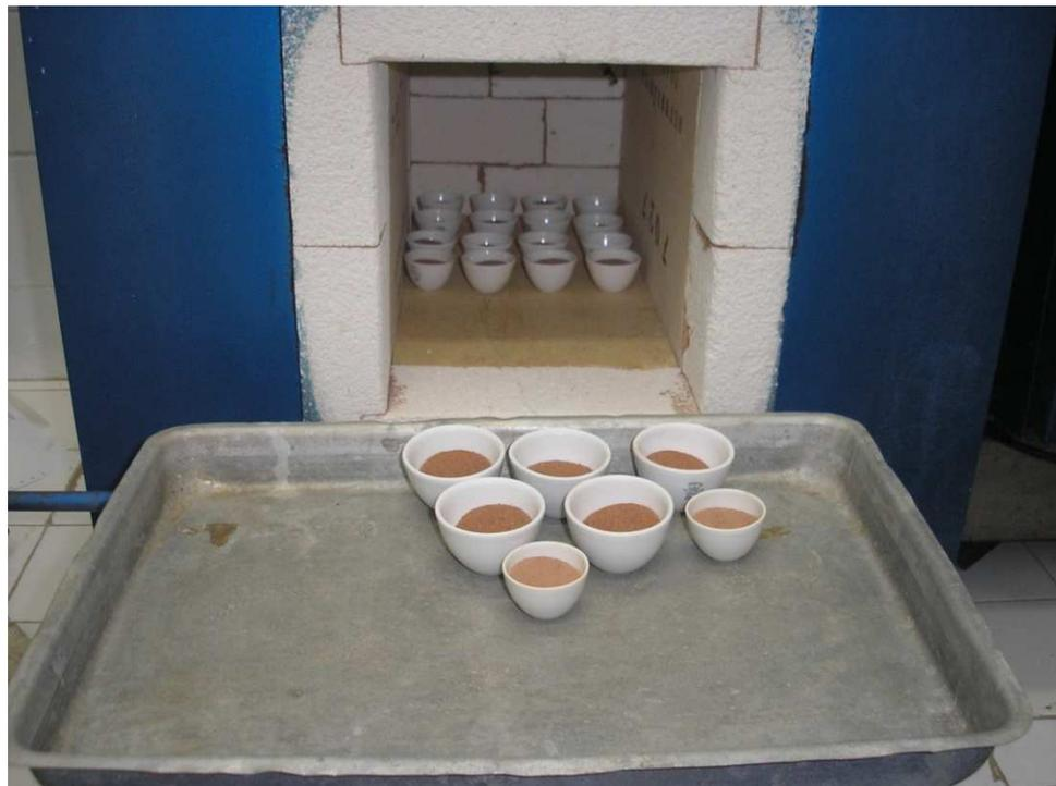
Figura 26 – Queima da matéria orgânica nas amostras no forno mufla.
