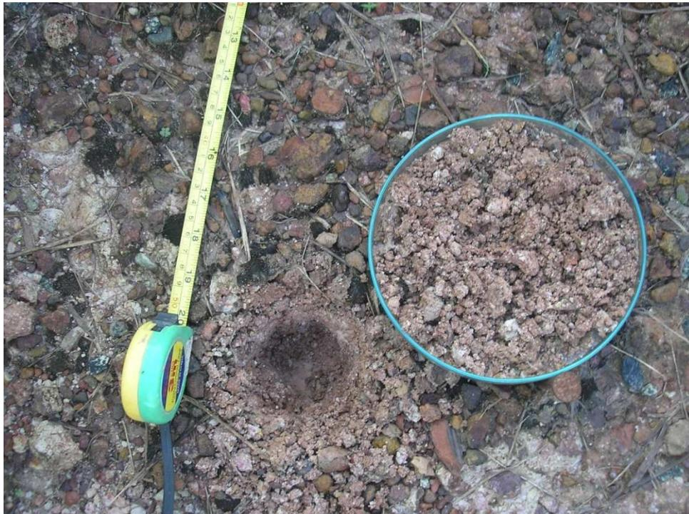
Figura 4 – Coleta das amostras na profundidade de 5 cm na parcela com solo exposto b. Foto: Bezerra, 2009.
