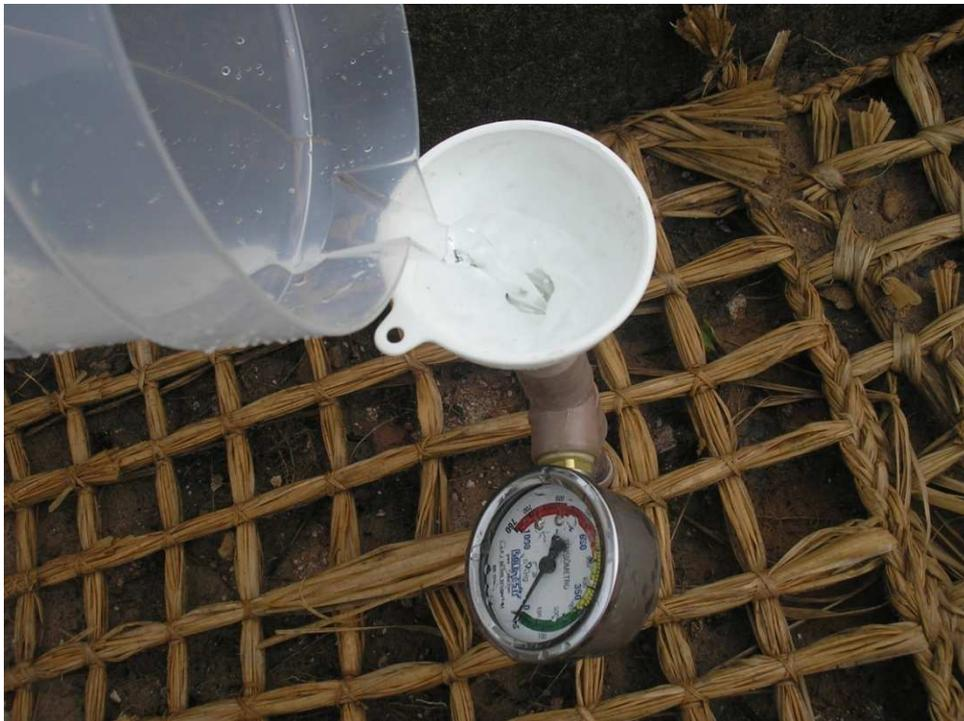
Figura 18 – Preenchimento de água nos tensiômetros.
