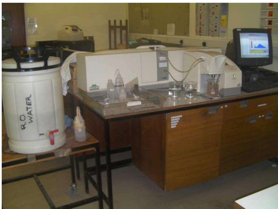
Figura 30 – Equipamento utilizado para a granulometria a laser. Foto: Bezerra, 2009.
