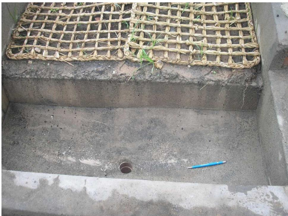
Figura 96 – Sedimentos depositados na calha da parcela com geotêxteis.
