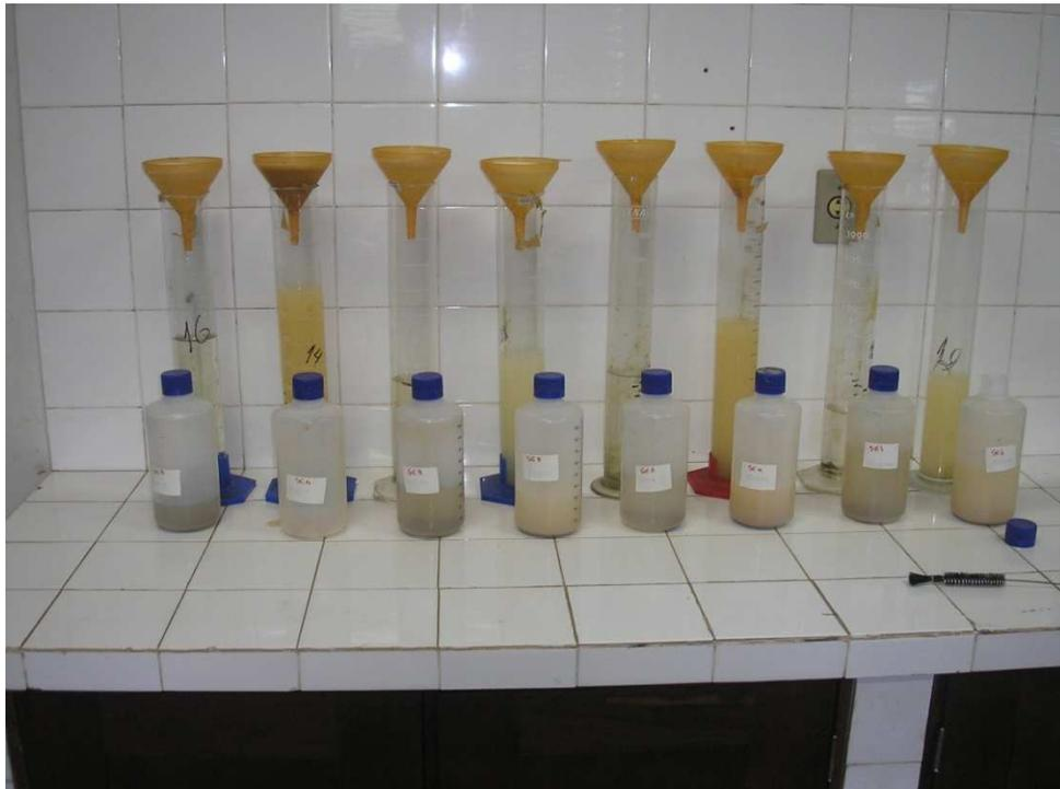
Figura 25 – Filtragem das amostras de água.
