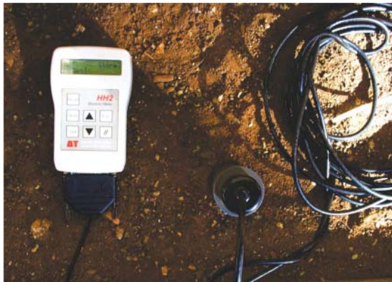
Figura 3 - Utilização do medidor de umidade superficial.
